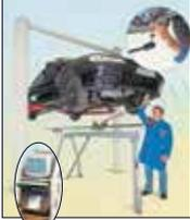
**NAJA**: Appareil piloté par ordinateur permettant le contrôle des véhicules avec une précision inégalée
